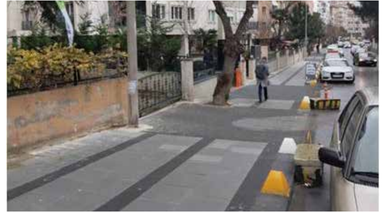
Göztepe Mahallesi, Karanfil Sokak'ta yol kesiti yeniden düzenlenerek yaya alanları genişletilmiş ve bisiklet yolu yapılmıştır.
